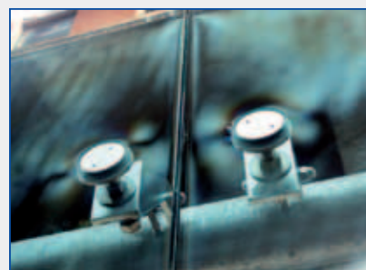
Foto realizzata tramite l'uso di lenti polarizzate che mostra la traccia delle tensioni realmente esistenti in una lastra di vetro forata svasata.
